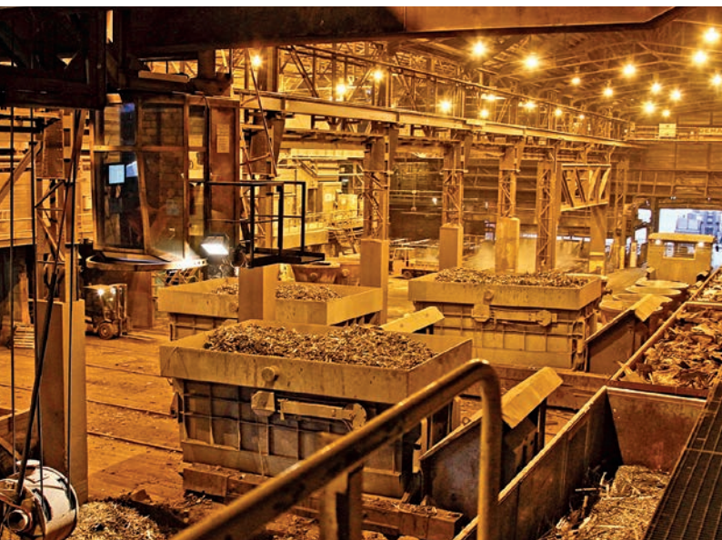
Halle im Stahlwerk Gerlafingen: Hier wird Stahlschrott in «Schiffe» geladen und anschliessend zum Elektrolichtbogenofen gebracht.
